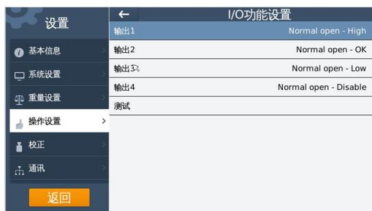
10 英寸屏幕共有 5 个输入选项、5 个输出选项和 1 个测试选项，连接报警灯时不需设置输入选项。
