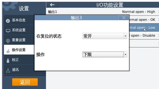
返回称重界面，设置上下限值，此时加载重量，报警灯的颜色会根据对应的重量来显示，重量超过上限，报警灯显示红色；重量在上下限之间，报警灯显示绿色；重量低于下限，报警灯显示黄色
